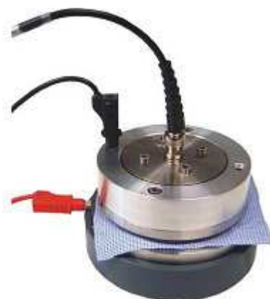
Измерение поверхностного сопротивления на заземленной опорной плите.
