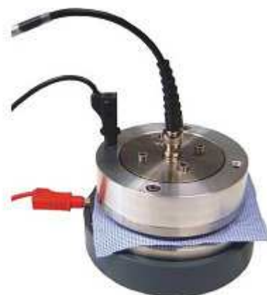
Измерение поверхностного сопротивления на заземленной опорной плите.
